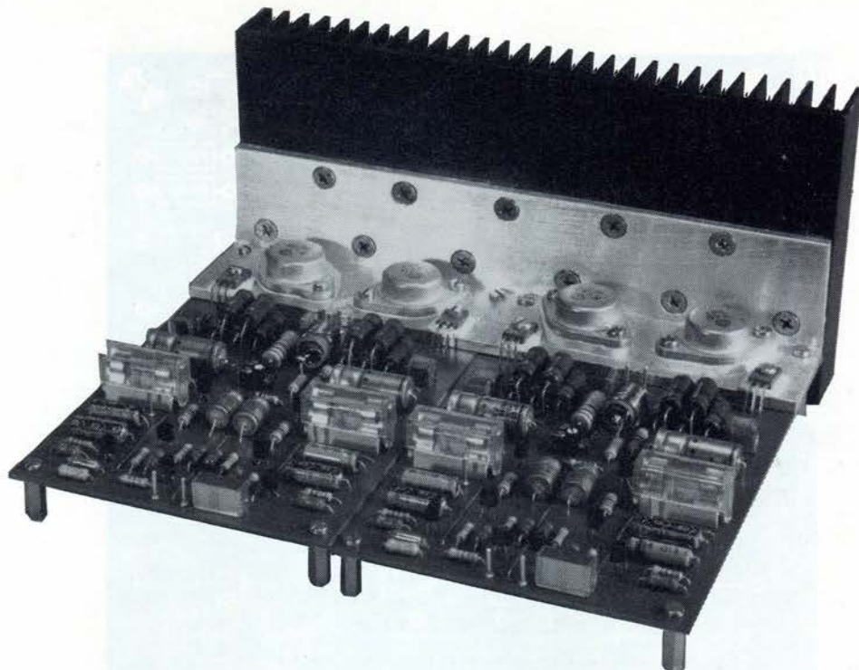
Figura 4. Il modulo completo dell'amplificatore consiste in due circuiti stampati, fissati al dissipatore termico per mezzo di una staffa di alluminio.
